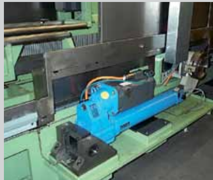
Beschickung Bearbeitungszentrum ATLANTA EH6 Hubzylinder mit Servomotor Kugelgewindetrieb KG 63 x 20 Verfahrgeschwindigkeit 165 mm/s 1700 Zyklen / Tag
