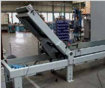
Aufrichter Möbelindustrie ATLANTA EH4 Hubzylinder Kugelgewindetrieb KG 50 x 20 1600 Zyklen / Tag
