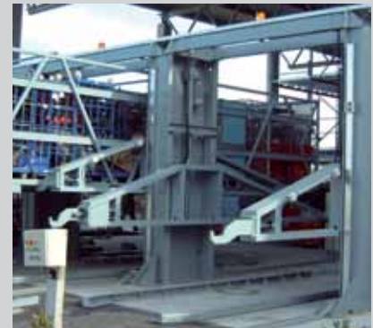
Verladeeinrichtung ATLANTA EH4 Hubzylinder Kugelgewindetrieb KG 50 x 10 Zwei Antriebe elektronisch synchronisiert Hub = 1500 mm
